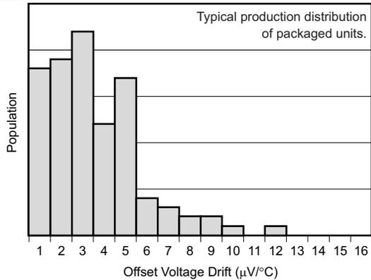
Figure 15. Offset Voltage Drift Magnitude Production Distribution
